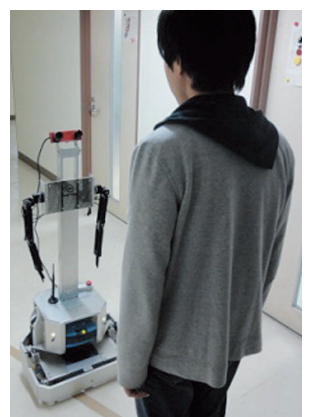
人間-ロボットインタラクション技術 ロボットが画像や音声などの情報を用いて特定の人物の識別や追跡をする。
