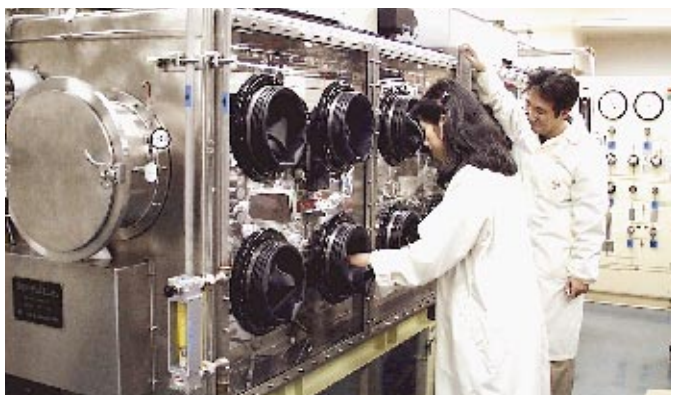
トリチウム取扱いシステム
