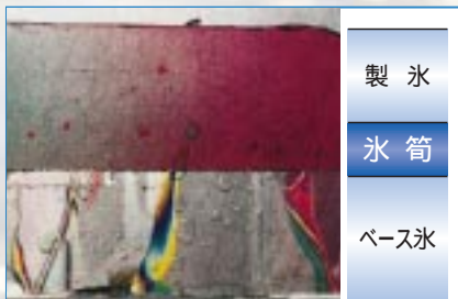
図4-2 ベース氷に張り付けた氷筒から成長した単結晶
