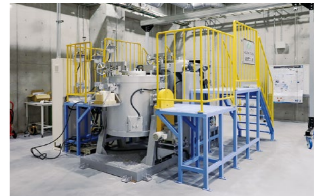
アルミニウム溶解精錬システム(アルミスクラップの溶解から鋳造まで一貫して行うことが可能)
