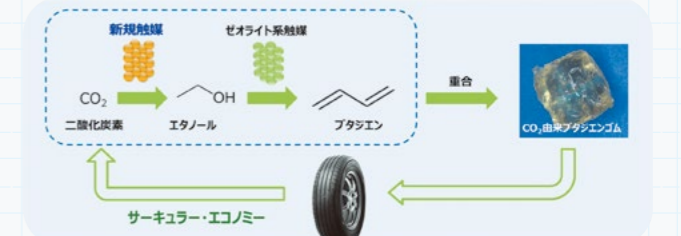
CO 2 を炭素資源として製品原材料に用いる技術によって成立する循環経済
