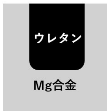
図2 Mg製ハンドル断面模式図
