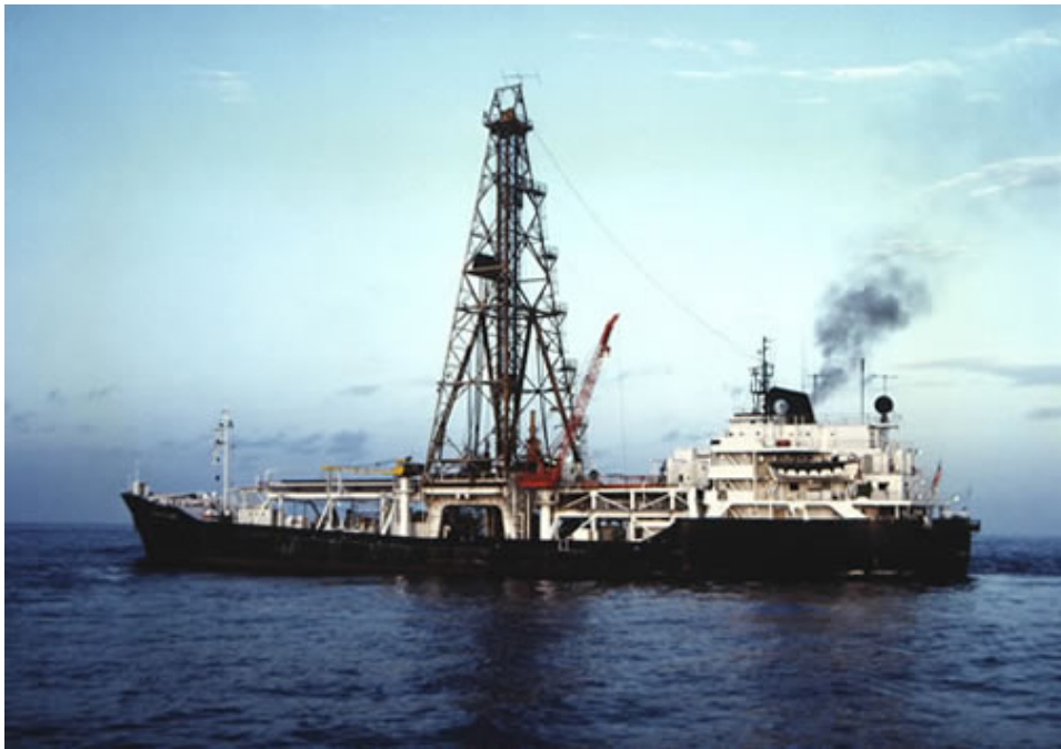
図 5. 米国の深海掘削船グローマー・チャレンジャー号。1968 年から 1983 年まで DSDP の主力船として活躍しました。(画像提供 : IODP/JRSO)
