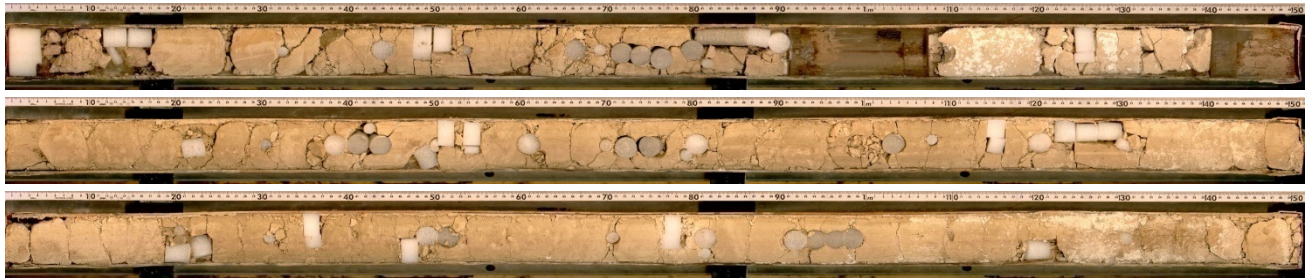
図 3. DSDP Site 296 海洋コアの一例 (Core 29R Section 1-3)。各コアの全長は約 1.5 m で、研究に供された試料の跡がスポンジで埋められています。現在よりも顕著に温暖だった中期中新世を連続的に記録した貴重な試料です。(画像提供：高知コアセンター)
